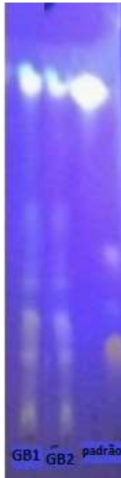
Figura 4 - Cromatografia em Camada Delgada das amostras GB1 e GB2 obtidas por Extração Assistida por Ultrassom. Revelação com NPPEG seguida de luz UV 350nm. Substâncias de referência: ácido fenólico, rutina e quercetina.
